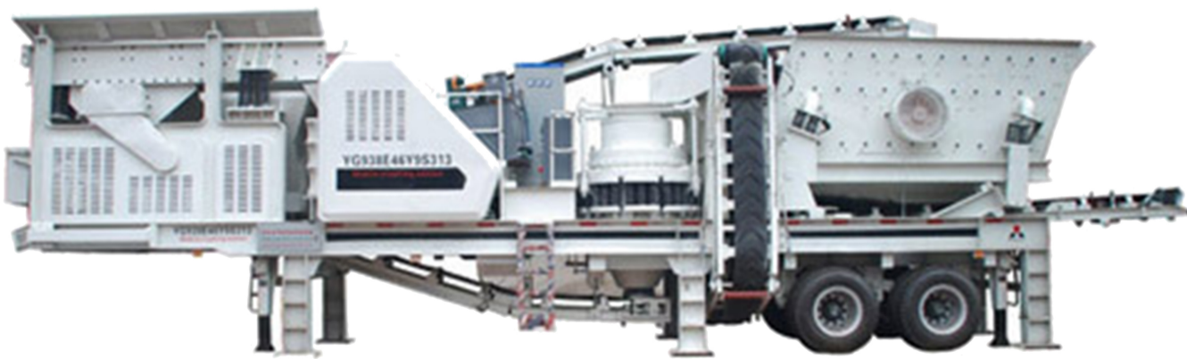
建筑垃圾破碎车
